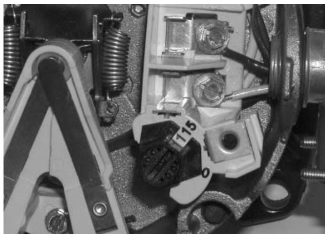
Figura 4: Motor configurado para 115 voltios
