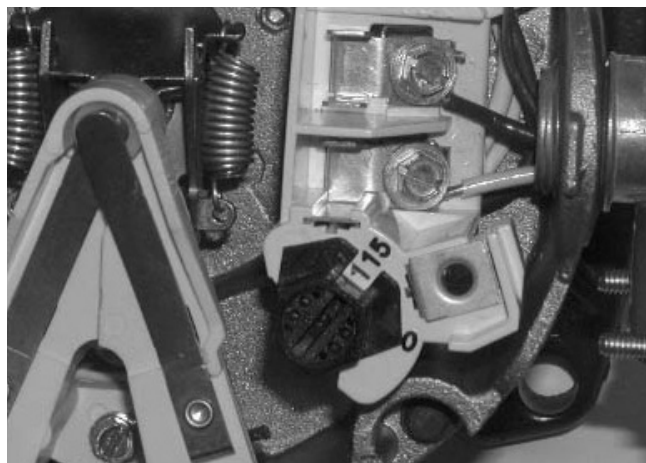
Figure 4 : Moteur réglé pour un fonctionnement à 115 volts
